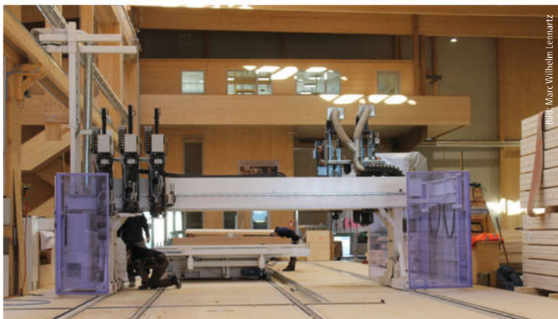
Die Maschinenteknik wurde so ausgelegt, dass ohne Umbauten parallel Holzständer- und Holzmassivbauprojekte realisiert werden können. Dazu dienen gleich zwei Abbundanlagen, die beide mit demselben 3D-Produktionsprogramm betrieben werden und den kompletten Fertigungsprozess von der Konstruktion über die Arbeitsvorbereitung bis hin zum fertigen Bauteil ermöglichen.
