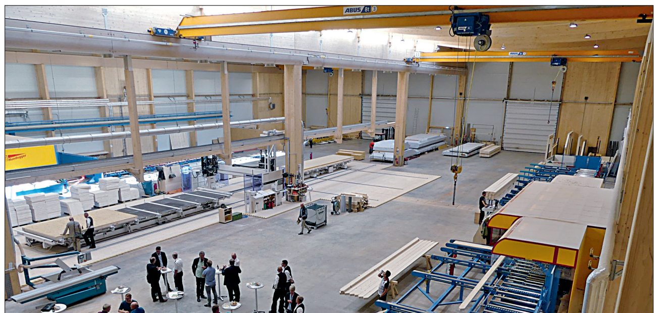
Blick in die CL-Tech-Produktionshalle: links im Hintergrund ein Hundegger-Portalbearbeitungszentrum (PBA), in der Mitte eine Weinmann-Multifunktionsbrücke (Wallteq M-380), die zwei in einer Linie angeordnete Arbeitstische bedient, und rechts ein Hundegger-Abbundzentrum (K2 Industrie). Oben im Bild sichtbar die Kranbahnen aus Buchen-Furnierschichtholz.
