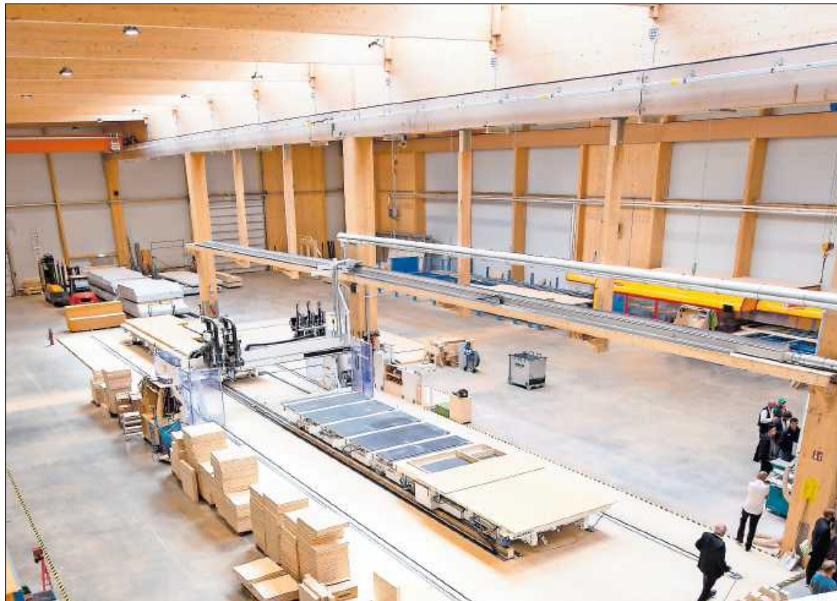
Der Automatisierungsgrad ist sehr hoch: Produziert werden in der 4200 Quadratmeter großen Halle im Industriegebiet Nord Brettsperrholz-Fertigteile für Einfamilienhäuser und Gewerbeimmobilien.
